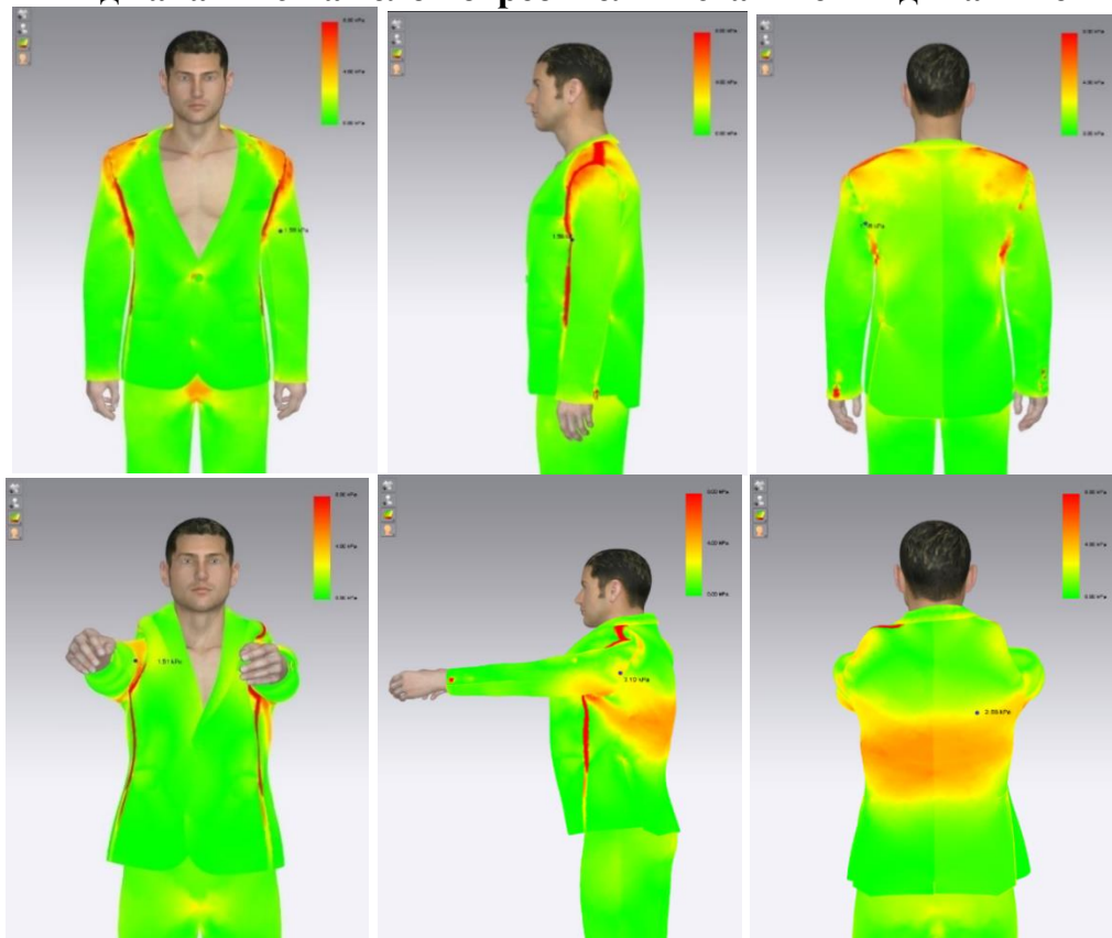
Рисунок 3.31 - Визуализация средних значений измерения давления модели пиджака M034 на тело потребителя в статике и в динамике
