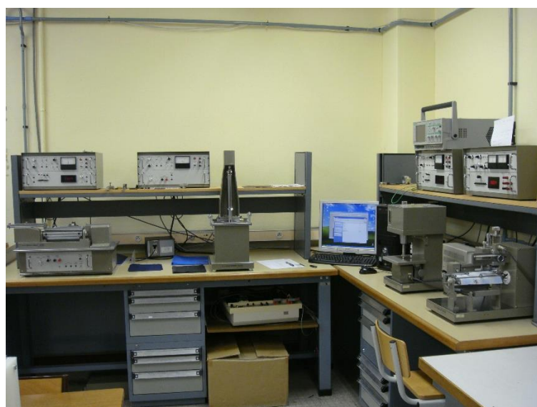
Рисунок 2.2 – Общий вид комплекса Kawabata Evaluation System for Fabric (KES-FB)
